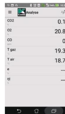
Mesure en temps réel sur tablette/smartphone
